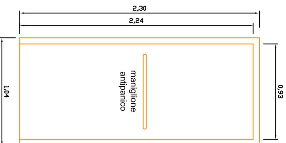
Struttura e rivestimento in legno avente stesse caratteristiche e tonalità di colore della parete dove è installata
